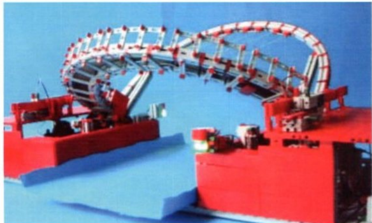
Links: De brug in opgeklapte positie, scheepvaartverkeer is nu mogelijk.
